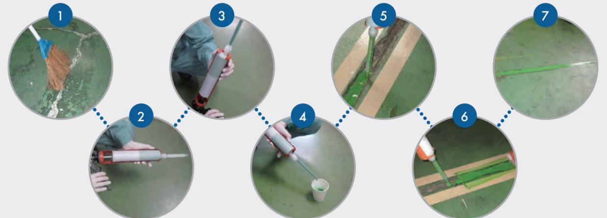
使用前にカートリッジをよく振ってから専用スタティックミキサーを取り付け、市販のコーキングガンにセットします。
