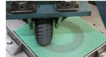
結果：リリーフペイントST、HGには全く剥離がないが、一般水性塗料は71.4%塗膜が剥離している。
