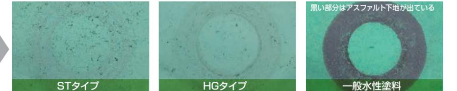
※1:タイヤに荷重をかけ120分間試験板を回し剥がれの様子を見る試験です、本来交差点など過酷な条件でのアスファルトの耐久性を測る試験です(塗膜試験用の一部条件変更)
